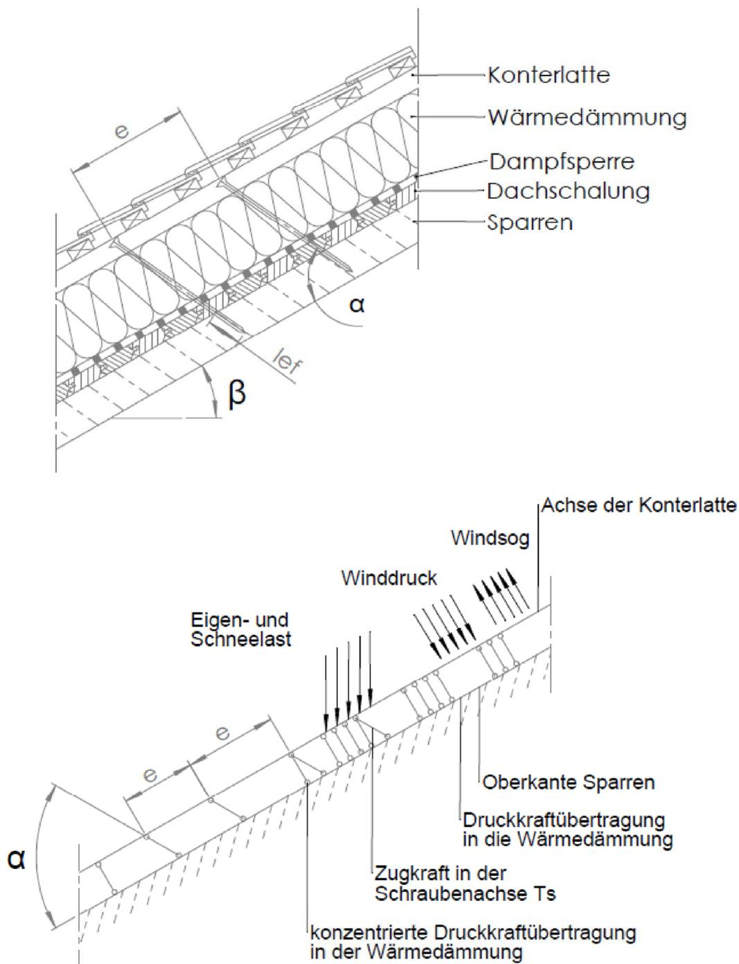
**Abbildung 3.1: Befestigung von Aufdach-Dämmsystemen auf Sparren- Statisches Modell für parallel angeordnete Schrauben**
