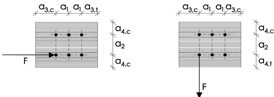
Abbildung A.2.2 Definition der Mindestabstände in den Stirnflächen des Brettsperrholzes. Bei Schrauben in den Stirnflächen sind die Abstände  $a_1$  und  $a_3$  parallel zur Seitenfläche sowie die Abstände  $a_2$  und  $a_4$  rechtwinklig zur Seitenfläche des Brettsperrholzes
